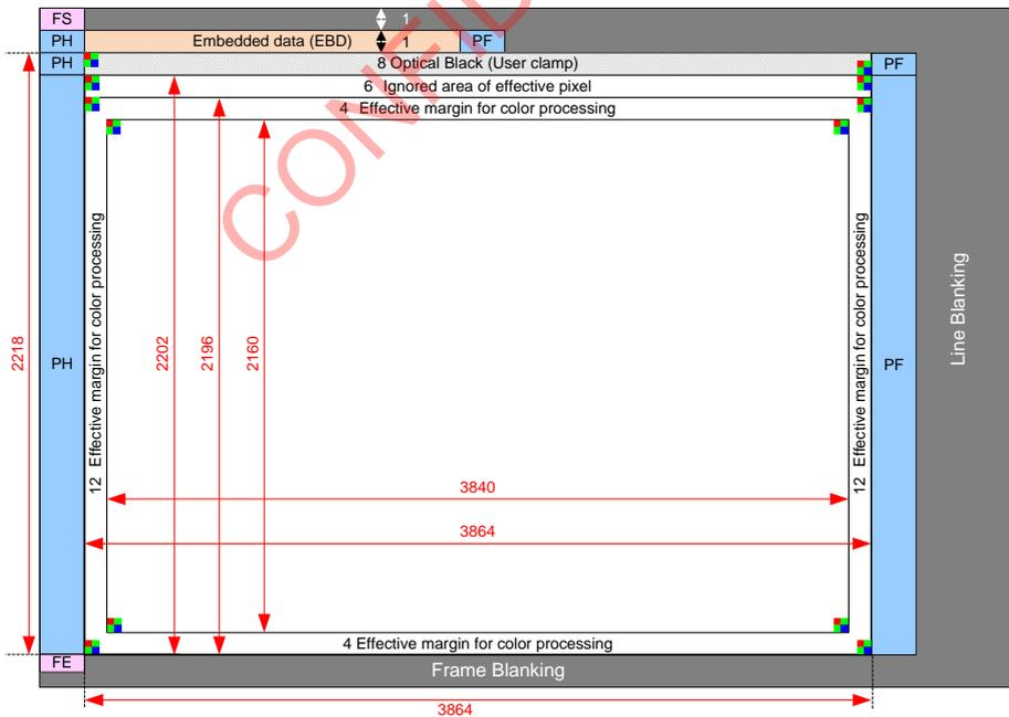
Readout Pixel Image Diagram (3840 x 2160)
