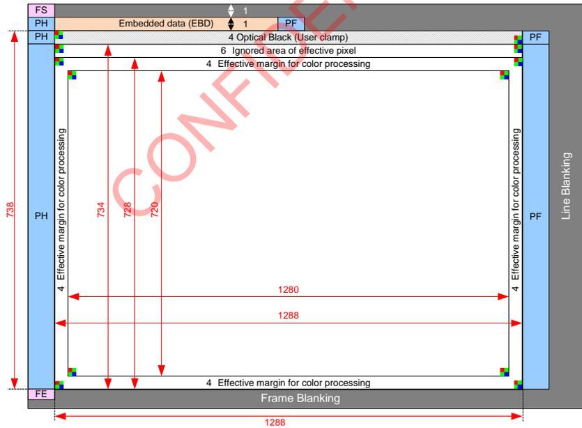
Readout Pixel Image Diagram (1280 x 720)
