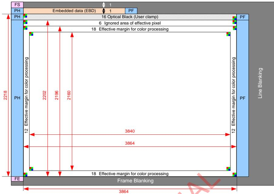
Readout Pixel Image Diagram (3840 x 2160)
