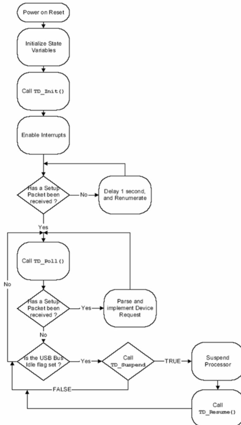
图 4.1 固件程序框架
